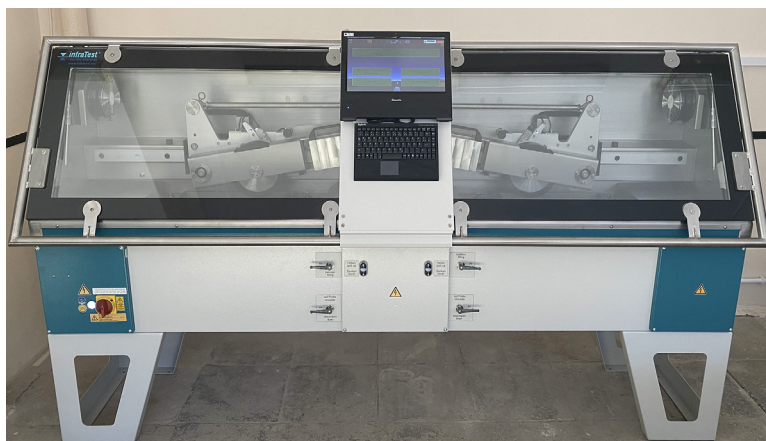
Рис. 3. Установка для проведения испытаний на колеобразовании «Infratest»
