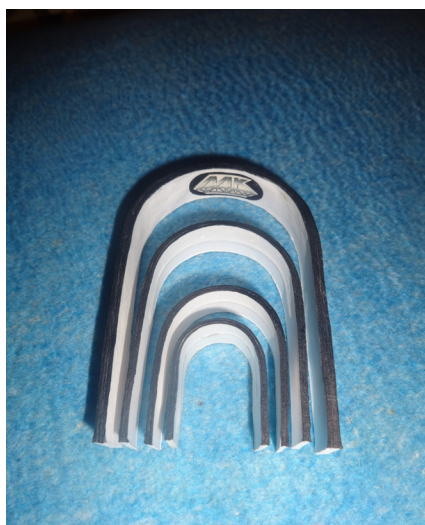
а Рис. 8. Снимок среза разнокалиберных U-образных профилей (а) и расчетная схема их сечения (б)
